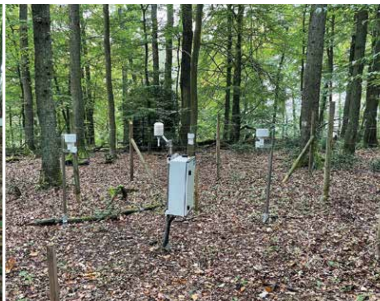
Bodenfeuchtemessstation auf der Dauerbeobachtungsfläche Arnsberg
